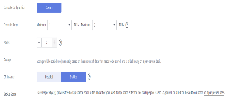
Figura 2-8 Especificações e armazenamento de uma instância sem servidor
